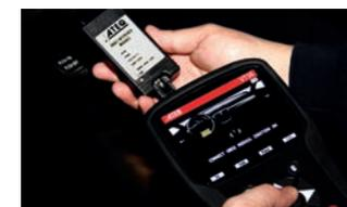
L'outil lit les codes TPMS DTC sur les véhicules applicables;
