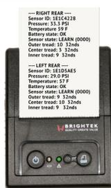
El medidor de profundidad de bandas de rodadura (TTD) es un accesorio opcional de la herramienta de diagnóstico TPMS VT56 para OBD2. Este accesorio permite a los mecánicos medir con gran exactitud la profundidad de las bandas de rodadura durante la comprobación de los sensores TPMS en el desarrollo de tareas rutinarias de mantenimiento y reparación. Con un simple gesto, el equipo permite detectar el desgaste o el daño de los neumáticos, además de indicar una alineación incorrecta de las ruedas
