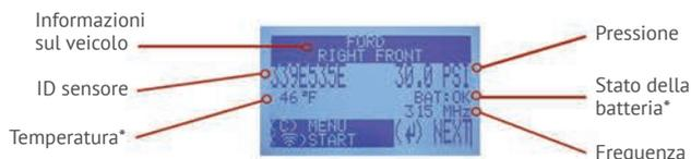
\* È possibile che alcuni sensori non visualizzino la temperatura e lo stato della batteria.
