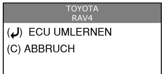
**Hinweis:** Diese Mitteilung wird auf dem Bildschirm angezeigt, wenn alle Sensoren ausgelöst wurden und das **OBD2-Modul** an das **TPMS-GERÄT** angeschlossen wurde.
