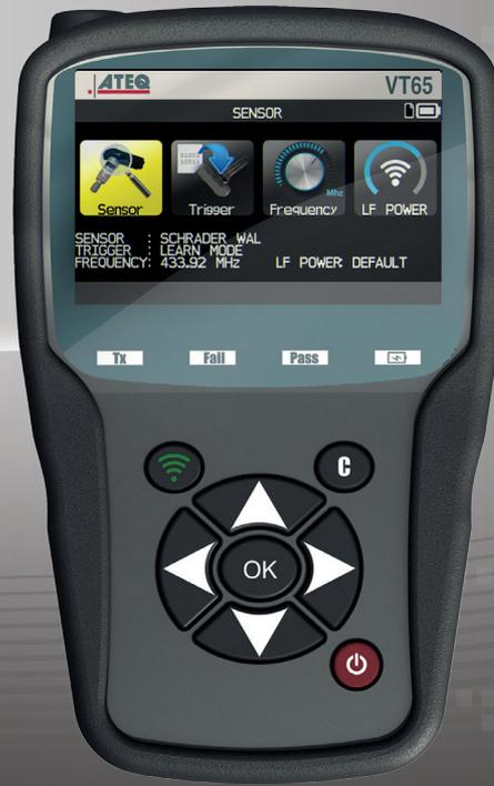
PARA LA PREPARACIÓN Y REVISIÓN DE VEHÍCULOS EN LÍNEAS DE PRODUCCIÓN DE AUTOMOCIÓN ACTIVA, PRUEBA Y TRANSMITE DATOS DEL SENSOR TPMS AL VEHÍCULO O A UN PLC
