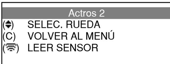
Para leer el segundo sensor, solo hay que presionar el botón «OK». La pantalla indica entonces que el VT TRUCK está listo para leer el segundo sensor: «Actros 2».
