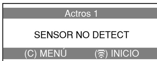
2: **FAIL** El sensor TPMS no funciona, no hay ningún sensor presente en el neumático probado o el VT TRUCK está mal colocado o demasiado lejos del sensor.
