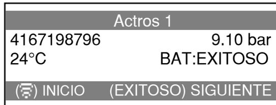
1: **PASS** El sensor se ha leído correctamente. La pantalla muestra: el ID del sensor, la temperatura en el interior del neumático, la presión medida y el estado de la batería del sensor TPMS.
