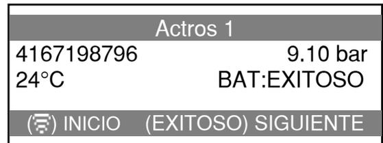
El sensor se ha leído correctamente. La pantalla muestra: el ID del sensor, la temperatura en el interior del neumático, la presión medida y el estado de la batería del sensor TPMS.
