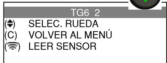
Para leer el segundo sensor, solo hay que presionar el botón «OK». La pantalla indica entonces que el VT TRUCK está listo para leer el segundo sensor: «TG6 2».
