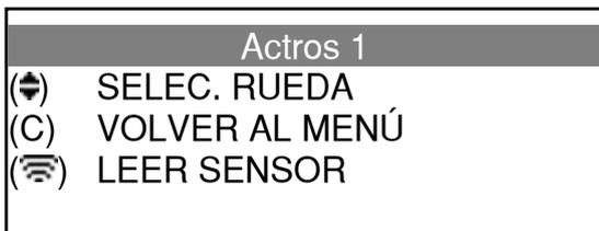
Presionar el botón «Activación del sensor» (de color verde) para iniciar el proceso de lectura del sensor TPMS.
