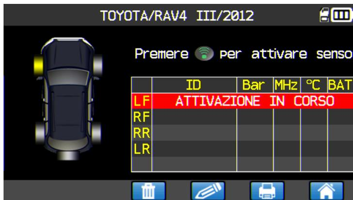
Lo strumento sta attivando il sensore.
