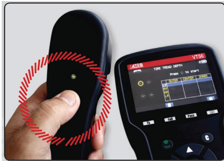
Quando tutte le ruote sono state misurate, vengono visualizzate le misure di tutti gli spessori.
