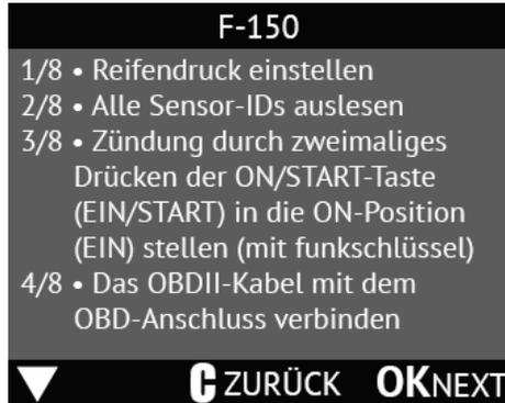
**6** Das Gerät fordert Sie auf, das OBD-Kabel mit dem Gerät und dem Fahrzeug zu verbinden. \*Vergewissern Sie sich, dass die Zündung eingeschaltet ist und drücken Sie OK.
