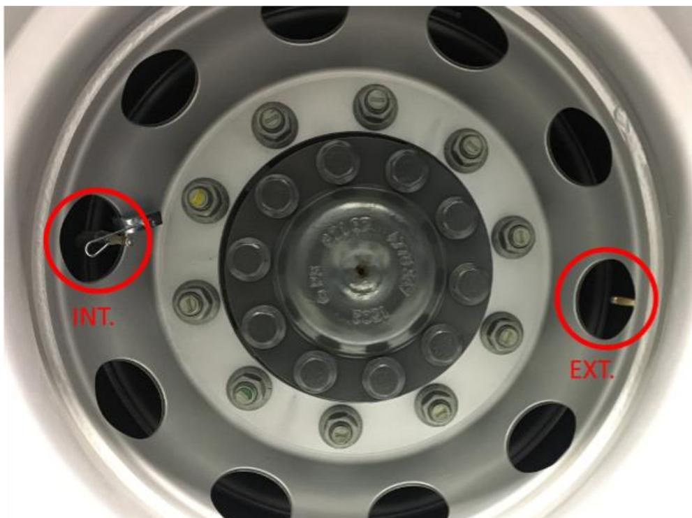
Lire simplement dans l'ordre recommandé (voir schéma page précédente) l'ensemble des roues équipées de capteurs TPMS. Le VT TRUCK prend automatiquement en charge l'ensemble des roues, y compris les roues jumelées.
