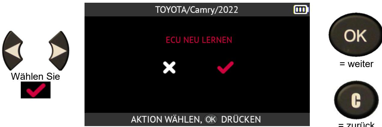
**Bitte beachten Sie:** Lassen Sie den Motor ausgeschaltet, während Sie die **Zündung eingeschaltet lassen**.
