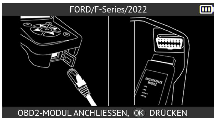
Schließen Sie das OBD-II-Modul an den OBD-Anschluss des Fahrzeugs an.
