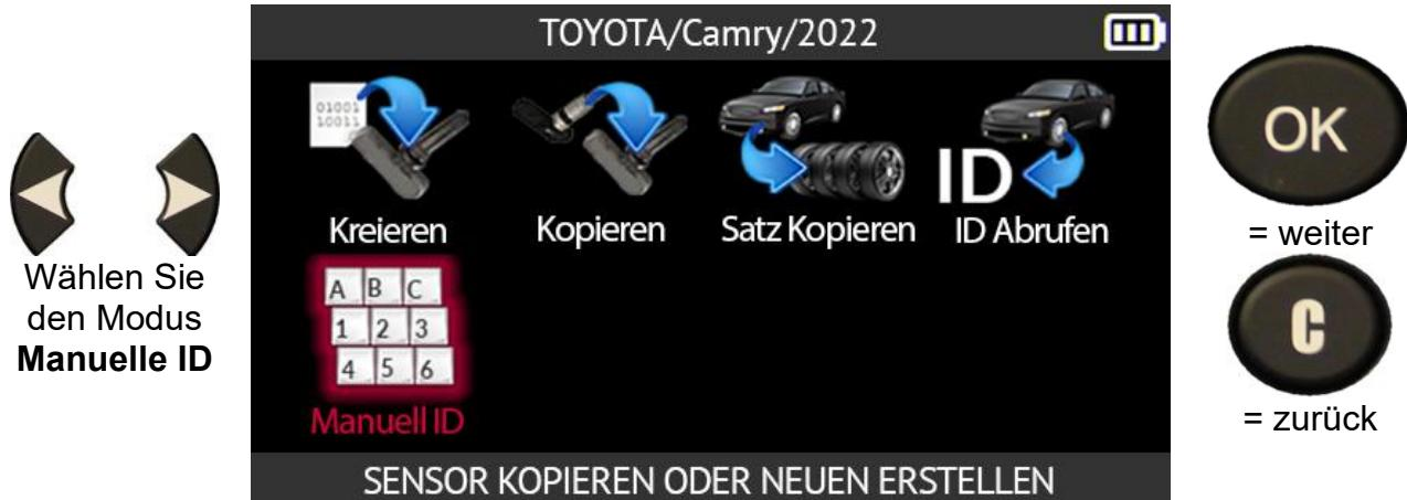
Das Tool wird Sie auffordern, eine gültige RDKS-Sensor-ID im richtigen Format (dezimal oder hexadezimal) einzugeben.
