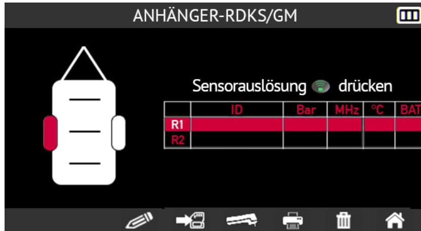
Wenn Sie die Sensoren eines Anhängers mit 12 Rädern überprüfen möchten, wird die Symbolleiste am unteren Rand des Bildschirms nicht angezeigt.
