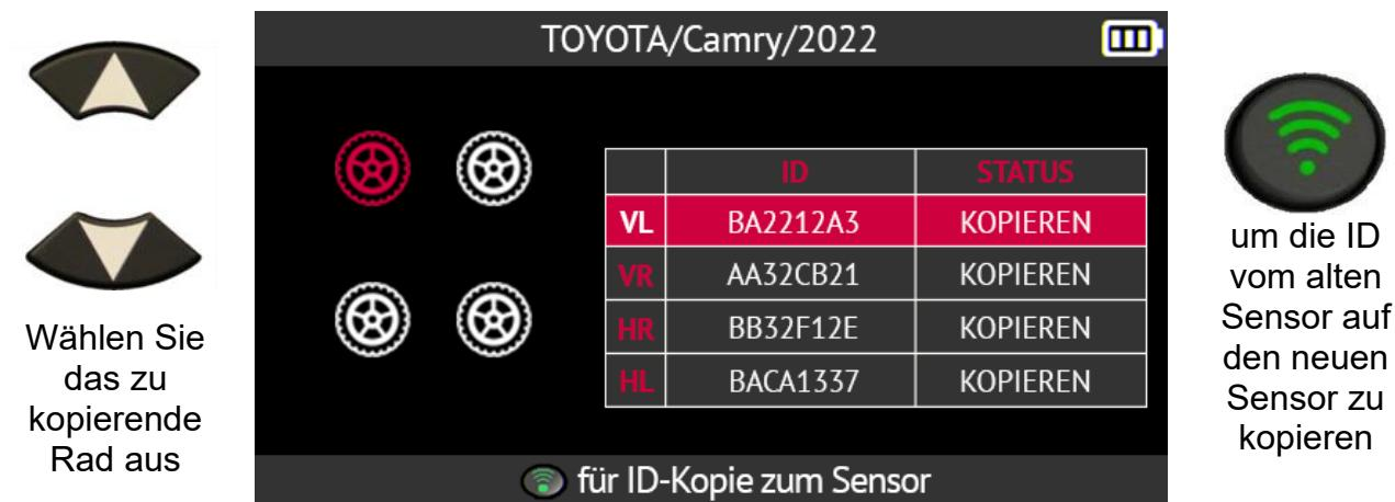
Positionieren Sie den ersten neuen Sensor über der Antenne des Geräts, um ihn zu programmieren.
