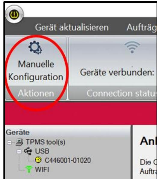
Das manuelle WiFi-Konfigurationsmenü für das Tool wird angezeigt.
