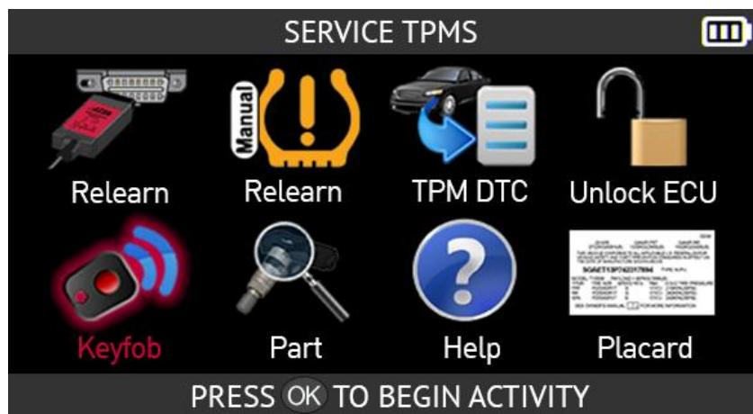
A seconda della marca e del modello del veicolo selezionato, lo strumento chiederà di scegliere la frequenza di comunicazione del portachiavi da testare.
