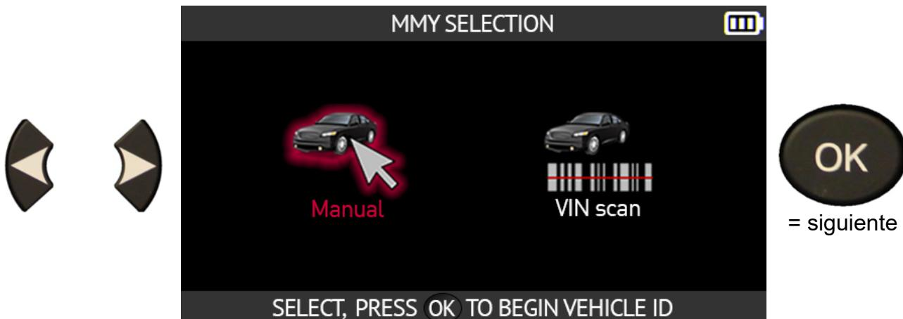
Utilice los botones de flecha para seleccionar el fabricante del vehículo. Pulse **OK** para confirmar su elección.
