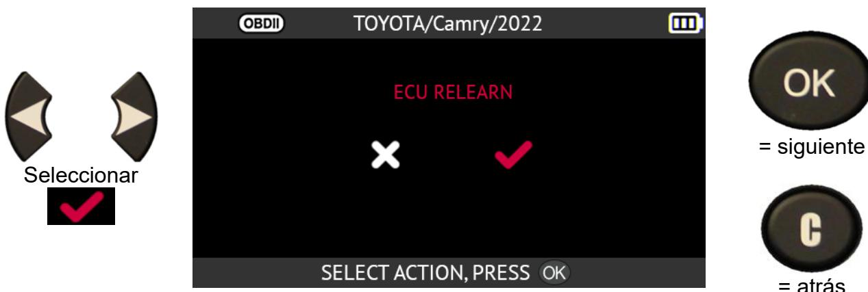
**Nota:** mantenga el motor apagado mientras mantiene el **contacto encendido**.
